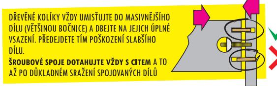
Zkompletujte čelo u hlavy sestavením dílů  $A_1$ ,  $B_1$  a  $B_2$  pomocí silnějších dřevěných kolíků a čtyř spojů se závitovými tyčemi (viz nákres DETAIL1). Současně mezi díly  $B_1$  a  $B_2$  vložte pomocí dřevěných kolíků hranoly  $A_2$ ,  $A_3$ ,  $A_4$ .
