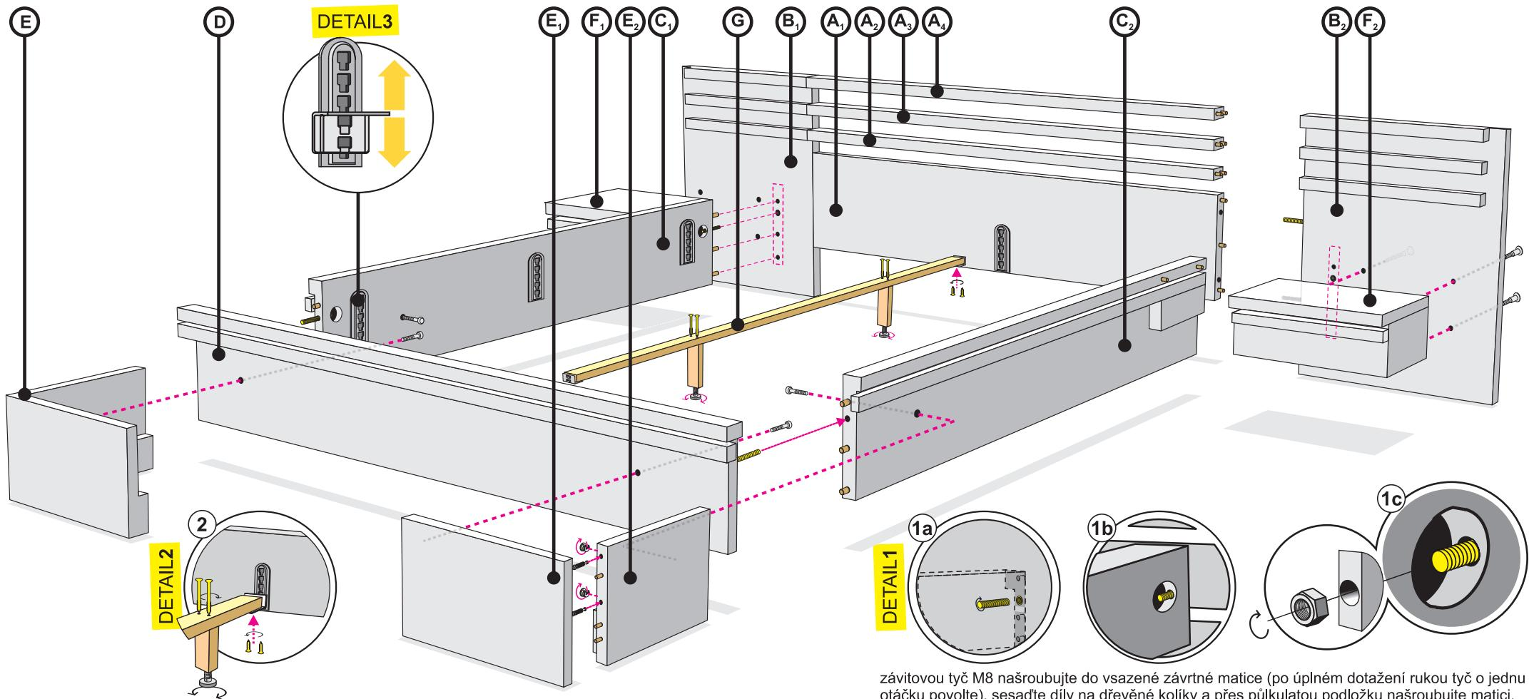
závitovou tyč M8 našroubujte do vsazené závrtné matice (po úplném dotažení rukou tyč o jednu otáčku povolte), sesadte díly na dřevěné kolíky a přes půlkulatou podložku našroubujte matici, kterou s citem dotáhněte.
